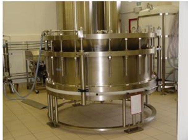
Figuur 9b: Opschaling in diameter: labschaal (1 cm diameter) naar productieschaal (200 cm diameter)
