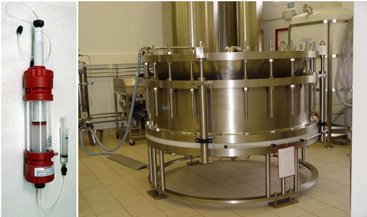
Figuur 5: Chromatografie kolom: Labschaal (links) en Productieschaal (rechts)
